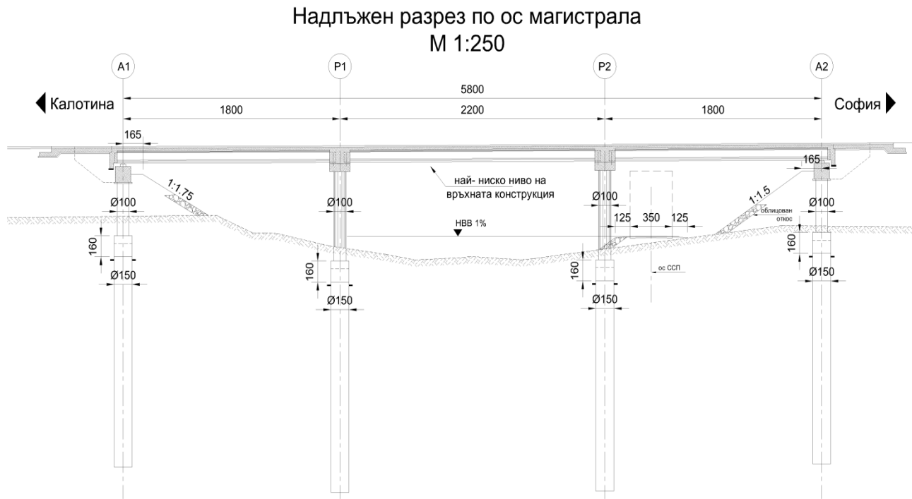
Фигура 4: Надлъжен разрез на моста над р. Белица(р. Костинбродска) при км 38+320 от АМ „Европа“
